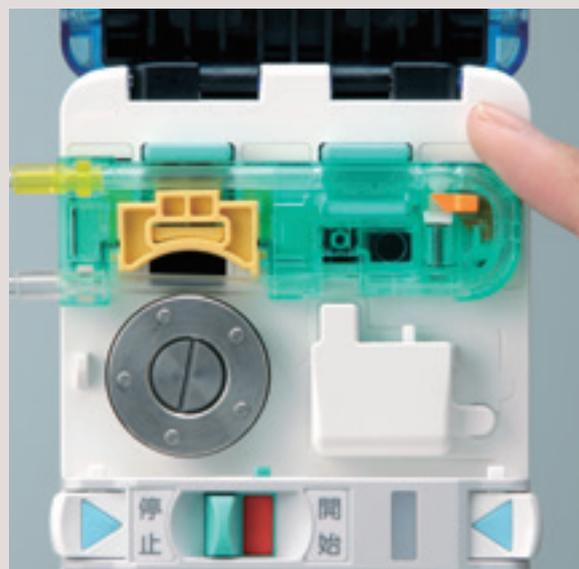
カセットに浮きがなく、チューブのかみ込み、折れ、つぶれ、たるみがないことを確認します。
